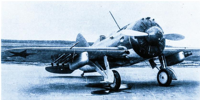
*Истребитель И-16 тип 29 с подвеской РС-82. Реактивные снаряды могли применяться против идущих в плотном строю вражеских самолетов, но в маневренном воздушном бою становились обузой, сильно ухудшающей маневренность и снижающей скорость.*
