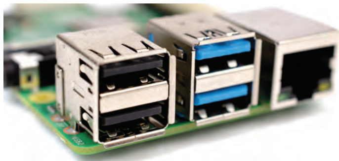
Рис. 1.6: USB-порты платы Raspberry Pi
