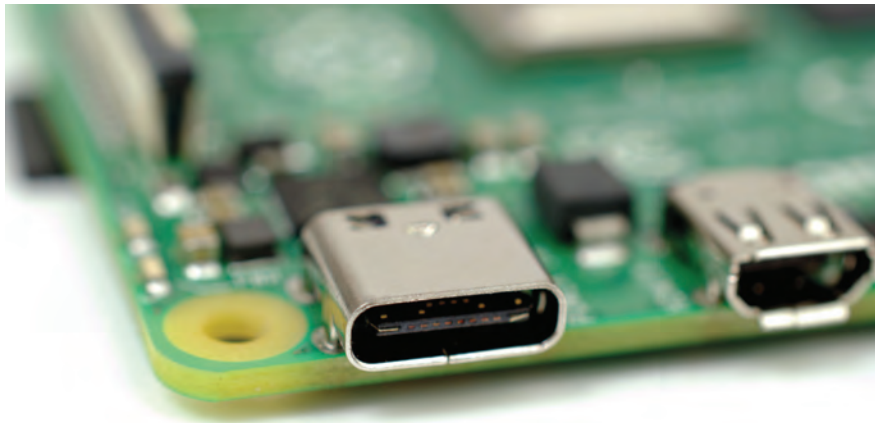
Рис. 1.11: Разъем USB Type-C платы Raspberry Pi
