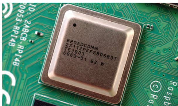
Рис. 1.2: Система на кристалле на плате Raspberry Pi
