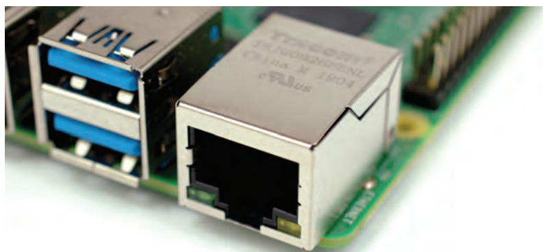
Рис. 1.7: Ethernet-разъем платы Raspberry Pi
