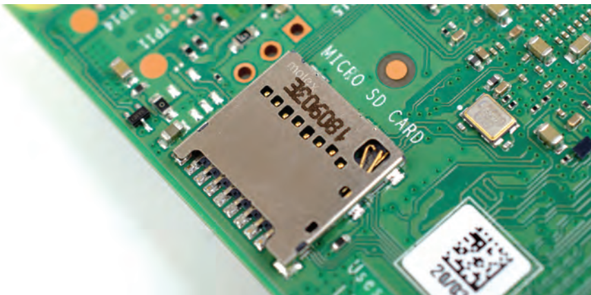
Рис. 1.15: Разъем для microSD-карты на плате Raspberry Pi
