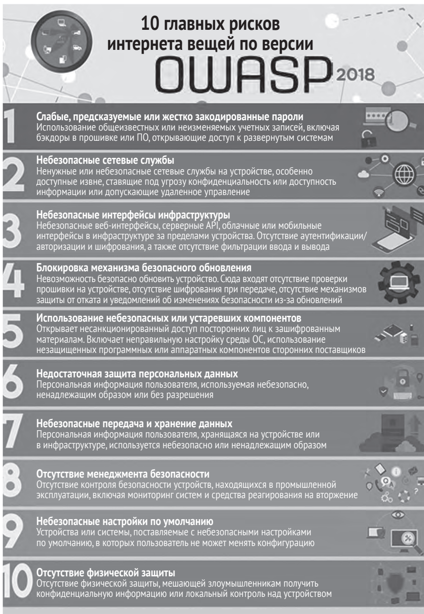
Рис. 1.3. Top-10 рисков в области интернета вещей: справочный документ Открытого проекта безопасности веб-приложений
