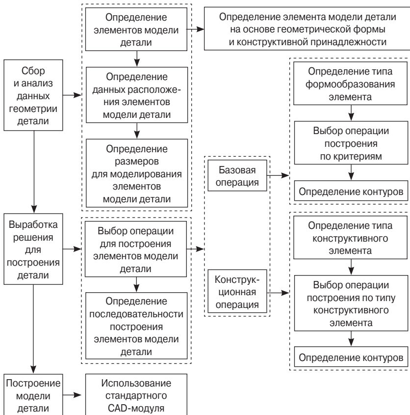
Стратегия построения электронной геометрической модели детали (модели детали)
