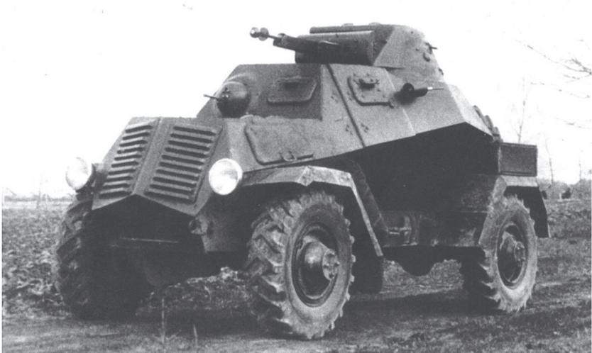
ЛБ-62 существовал всего лишь в двух экземплярах, пройдя полностью программу испытаний к середине мая 1941 года. Готовился проект постановления о начале серийного производства на заводе ГАЗ, но заводское руководство всячески этот процесс затягивало, мотивируя невозможностью перестройки производственных линий, загруженных дополнительно авиационными заказами.
