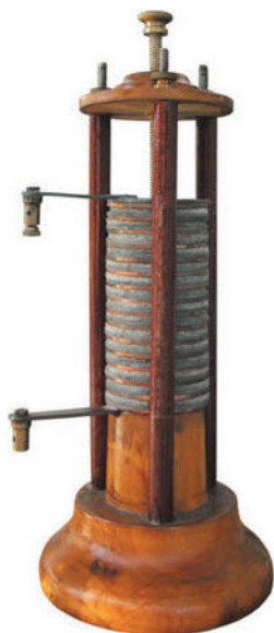
Вольтов столб, разработчик: Луиджи Кьеза, CC BY-SA 3.0
