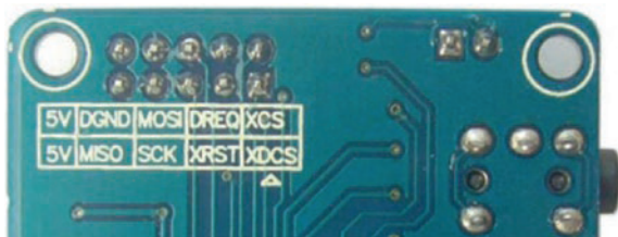
Рисунок 1-2. Соединения аудиоплаты VS1053 (плата перевернута в сравнении с рис. 1-1)
