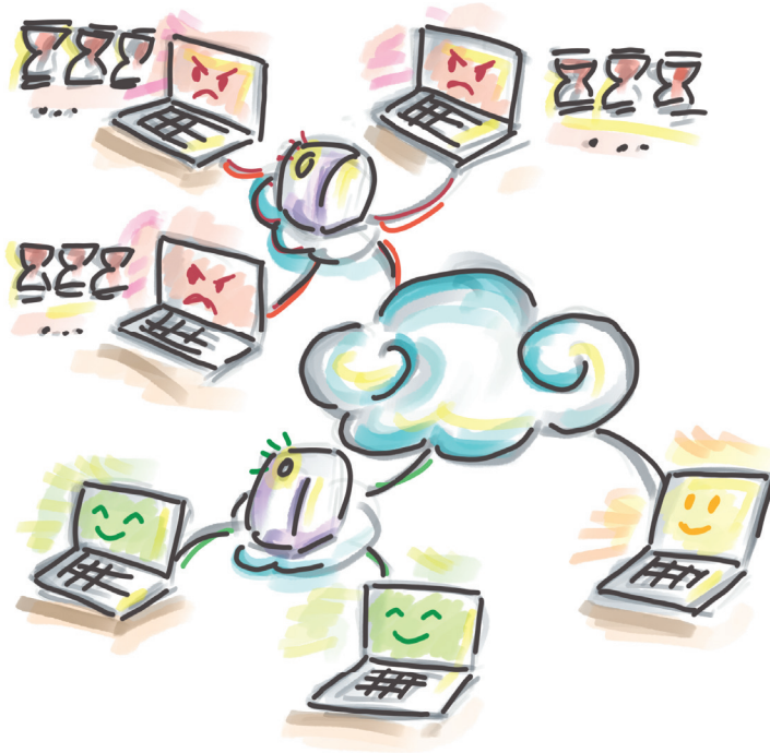
Рисунок 1.5 Время доступа к облаку может быть большим из-за нагрузки на сеть и сложной инфраструктуры. Доступ к облаку может занимать сотни миллисекунд или даже секунды. Его можно рассматривать как еще один уровень памяти, который еще больше и медленнее, чем жесткий диск. Повышение производительности облачных приложений бывает затруднено еще и потому, что время доступа или записи данных в облаке непредсказуемо
