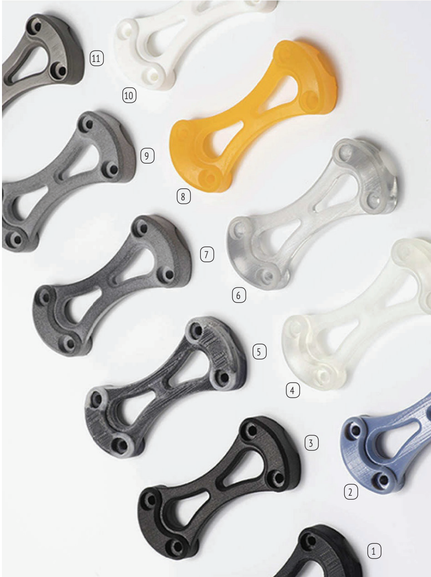
Рис. 1.3 ❖ Показаны различные напечатанные материалы: 1) ABS (FFF), 2) жесткая непрозрачная смола (струйная 3D-печать), 3) укрепленный графитом нейлон (SLS), 4) прозрачная смола (SLA), укрепленный углеродом нейлон (CFF), 6) смола высшей степени очистки (струйная 3D-печать), 7) HP-нейлон (мультиструйная плавка), 8) литьевая смола (DLP), 9) серый PA12 нейлон (SLS), 10) белый PA12 нейлон (SLS), 11) инструментальная сталь (DMLS)
