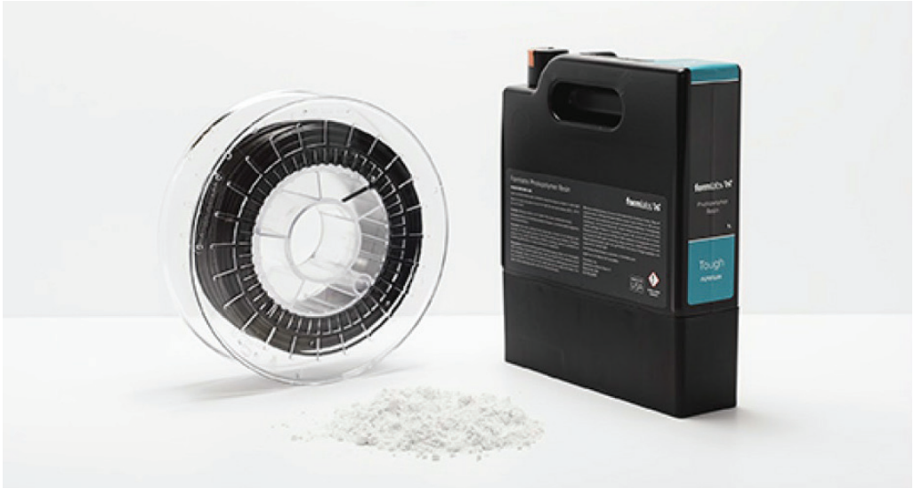
Рис. 1.2 ❖ Катушка филамента для FFF (слева), нейлоновый порошок для SLS (середина), контейнер смолы для SLA (справа)
