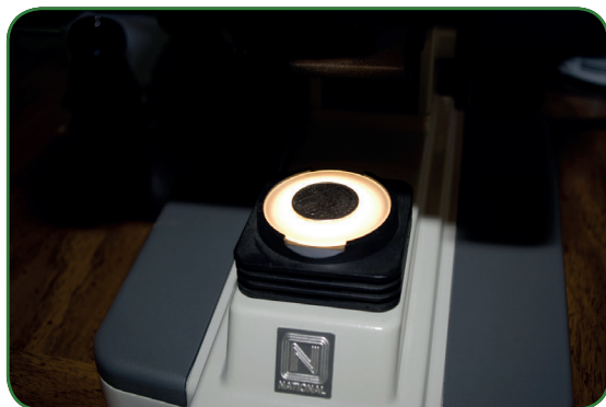
Рис. 1.1.6. Готовое устройство для темнопольной микроскопии
