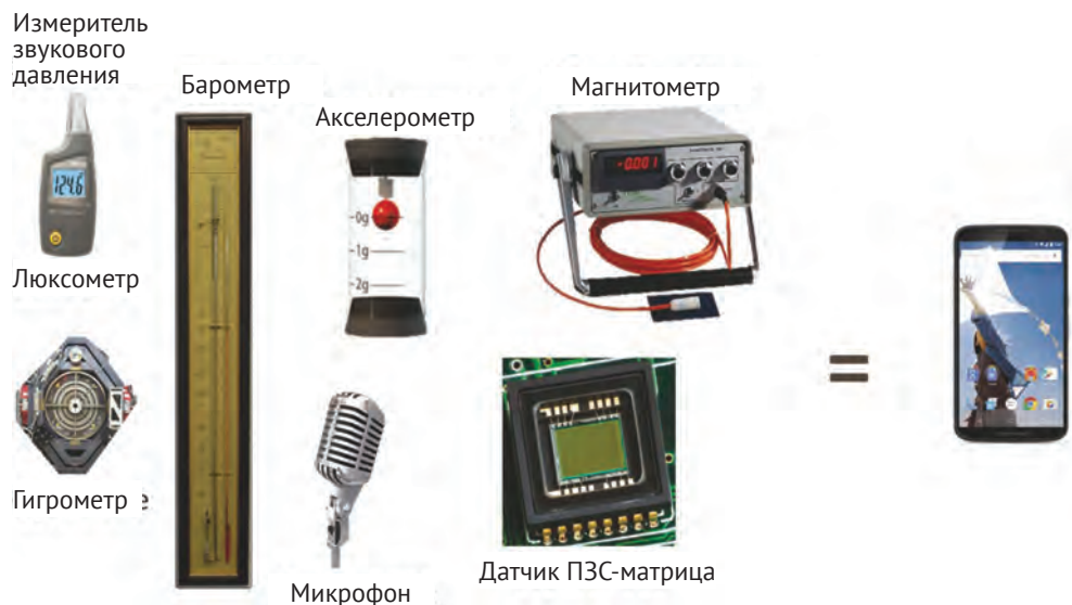
Рис. 1.3. Смартфон – это настоящая мини-лаборатория. Показаны примеры датчиков, встроенных в смартфоны
